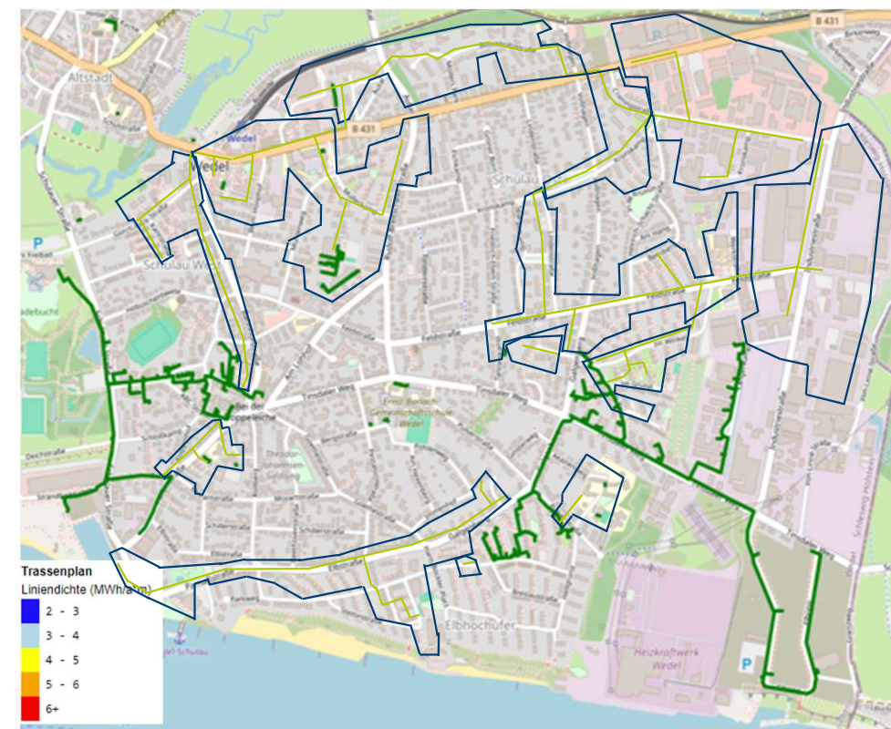
Abbildung: Ergebnis des iterativen Prozesses zur Festlegung von neuen Trassenverläufen und Fernwärmeausbaubereichen aus dem TraFo-Plan Schulau
