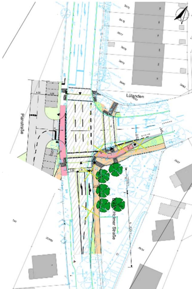
Abb. 9: Lageplan des Umbauvorhabens der Kreuzung Holmer Straße (B431) / Lülanden, Planungsstand Juni 2024, ohne Maßstab, Planverfasser: Wasser- und Verkehrs- Kontor GmbH, Neumünster
