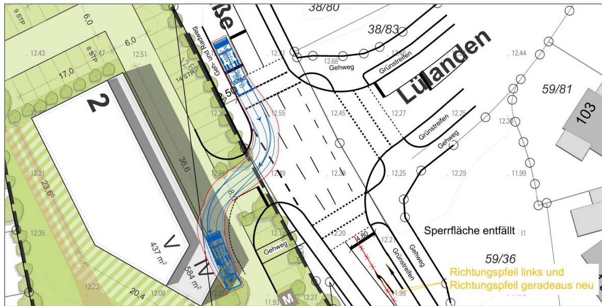
Abbildung 5.3: Schleppkurve Müllfahrzeug von Norden
