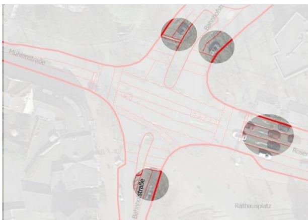
Abbildung 67: Knotenpunkt-Umgestaltung - Fahrstreifenreduzierung
