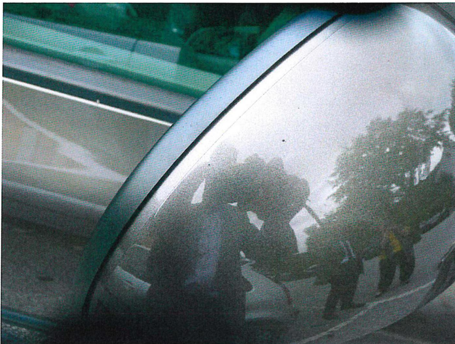
Bild 2: Beispiel eines geschädigten Bereichs eines lackierten Kunststoffs (Seitenspiegel)
